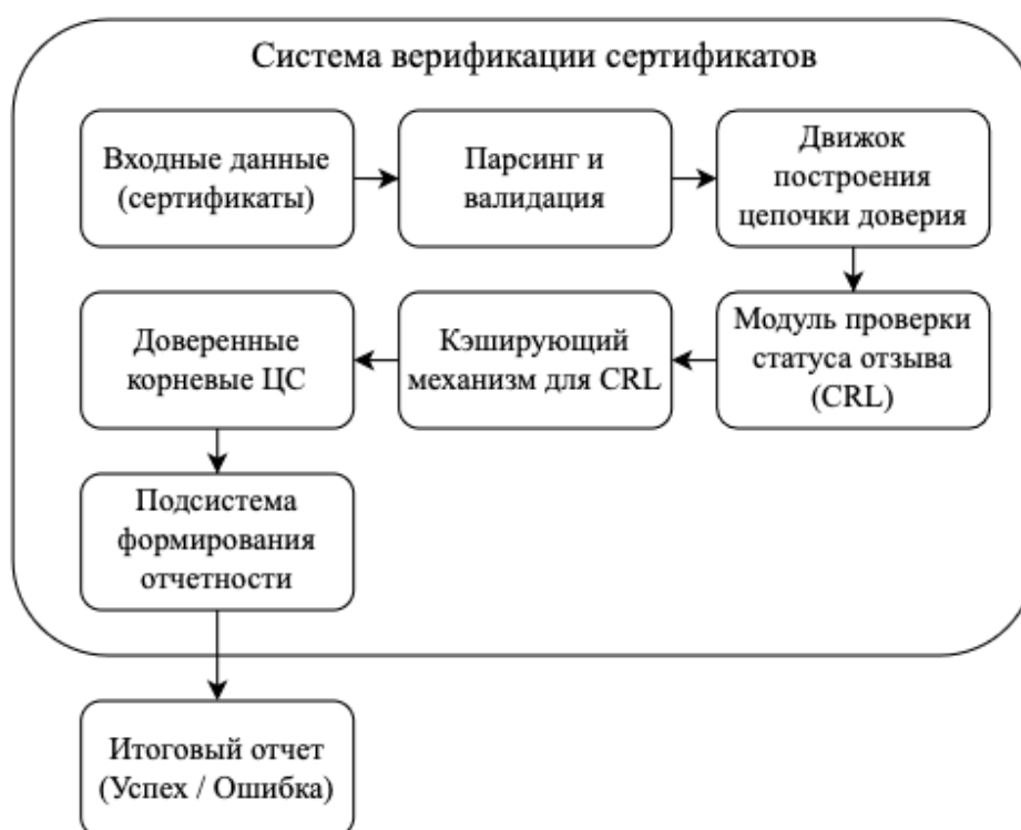
Рис. 1 – Структурная схема системы верификации цепочек сертификатов X.509
