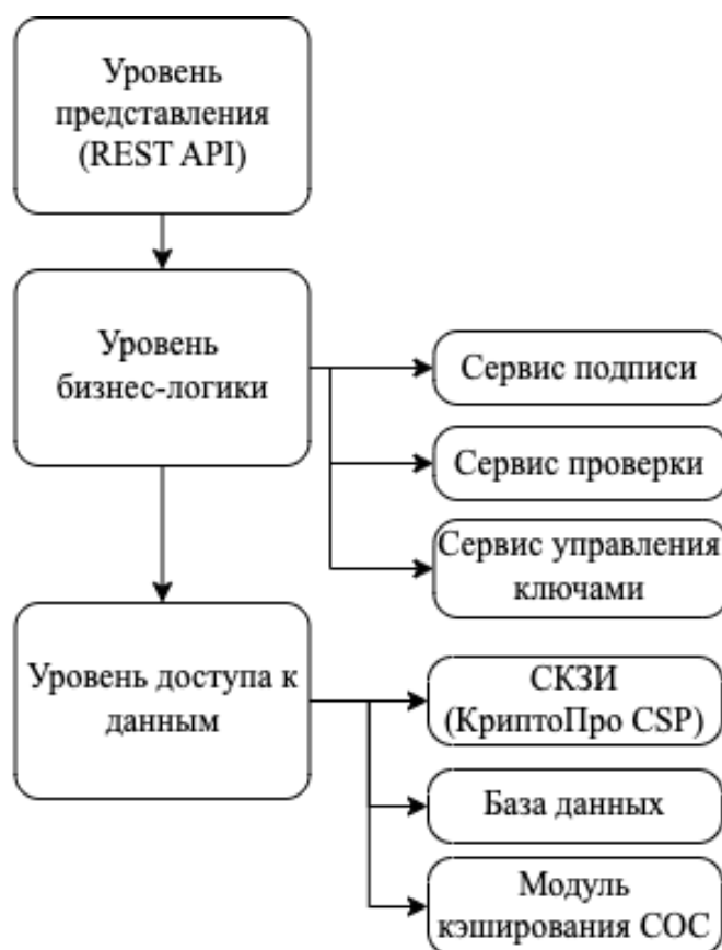
Рис. 3 – Многоуровневая архитектура модуля ЭП
