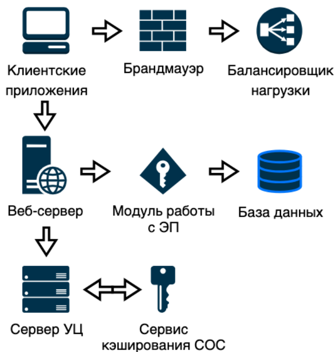
Рис. 1 – Общая архитектура системы электронного документооборота
